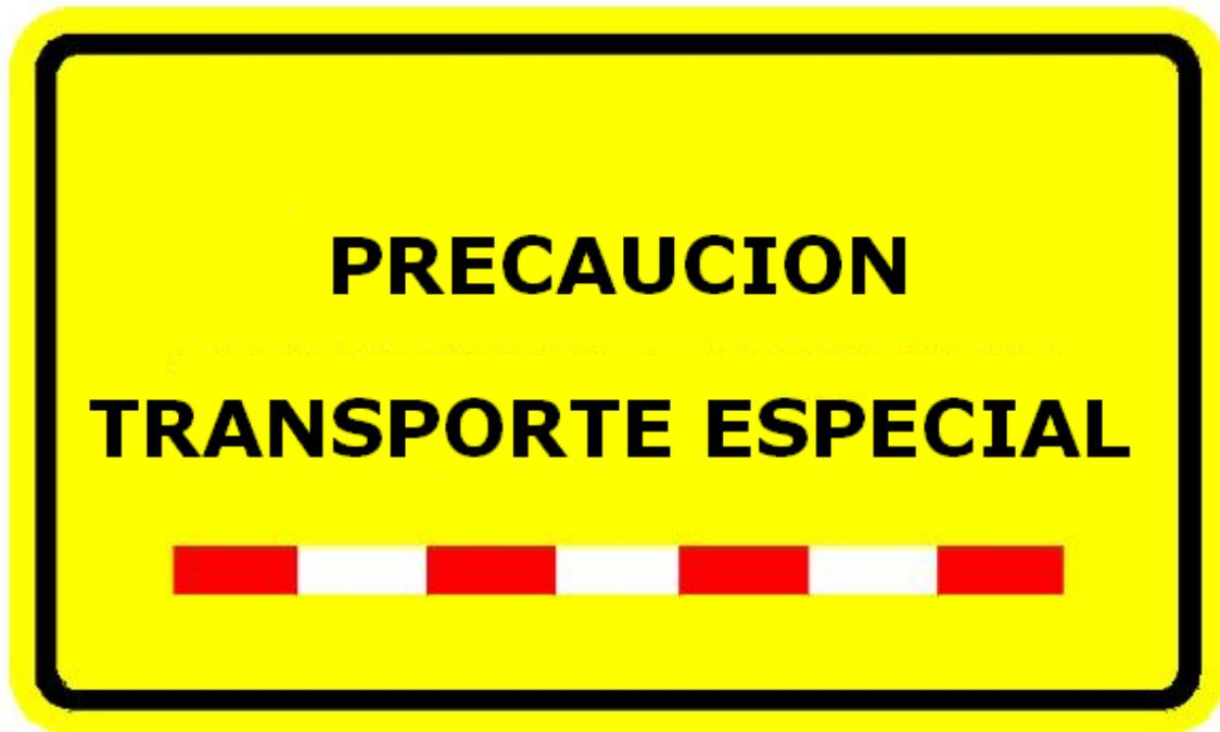
El transportista debe instalar esta señal en la parte posterior del vehículo a una altura de 1,5 [m] medidos desde el piso hasta la parte inferior del letrero.
