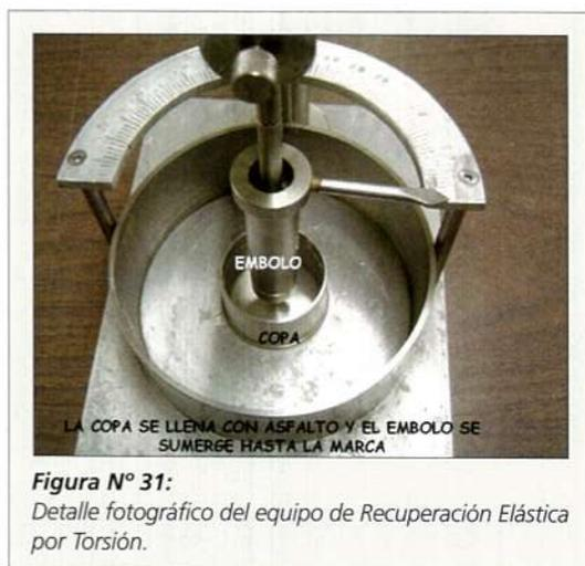
**Resumen del Método:** La muestra es torcida dentro de un cilindro hasta un ángulo de 180°, a velocidad y temperatura preestablecidas. Después de lo cual se suelta. Transcurridos 30 min., se mide el ángulo de recuperación de la muestra con la cual se determina el porcentaje de recuperación elástica por torsión.
