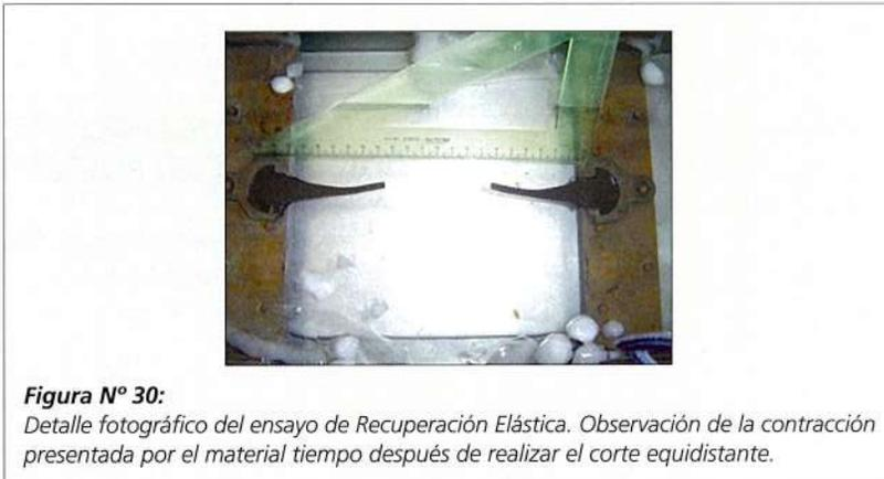
**Resumen del Método:** Se prepara una briqueta de ductibilidad, la cual es estirada hasta 20 cm., a velocidad y temperatura específicas. Después de lo cual se corta a una distancia equidistante de ambos extremos. Transcurridos 60 min, se calcula la distancia de contracción sufrida por la muestra con la cual se determina la recuperación elástica porcentual. Anote la longitud recuperada entre ambos extremos cortados de la muestra. Se calcula el porcentaje de recuperación como:
